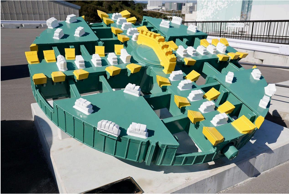
処理水を海洋放出するための海底トンネルの掘削に使われた「シールドマシン」の一部=2024年10月21日、東京電力福島第1原発（土師野幸徳撮影）
