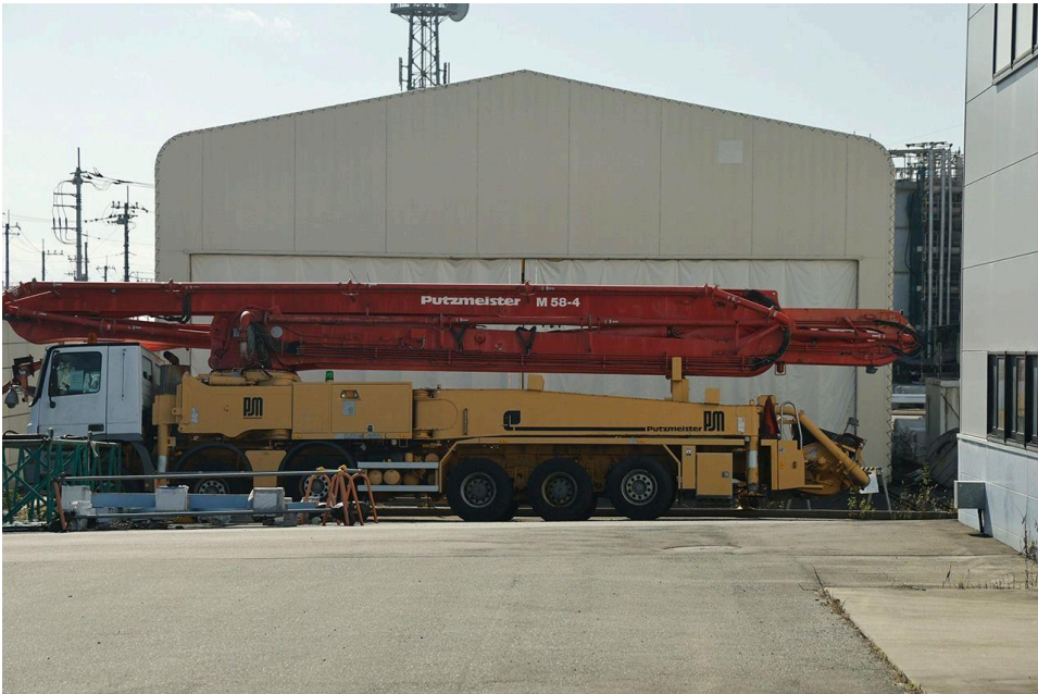
事故直後に原子炉建屋内の使用済み燃料プールの冷却で活躍した車両。長いアームを生かして建屋上部から放水し、「キリン」の愛称で呼ばれた＝2024年10月21日、東京電力福島第1原発（土師野幸徳撮影）
