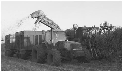
サトウキビの機械化収穫作業（専用の大型収穫機と伴走するリフトダンプ付きのトレーラー）
